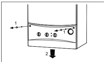
Рисунок 7.4 Вынимание двух шурупов
