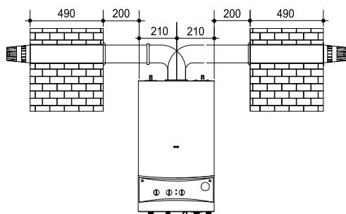
Рисунок 7.12 вывод трубы
