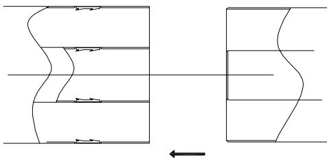
Рисунок 7.8. О – образная прокладка в дымовой трубе
