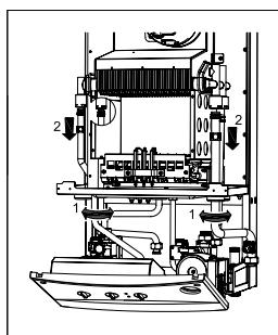
Рисунок 10.7 Отсоединение датчиков, датчика защиты от перегрева, четырех медных труб и теплообменника
