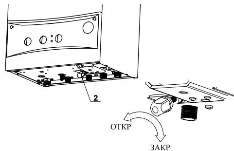
Рис. 4.3 Кран доливания воды
