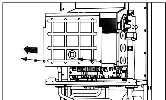
Рисунок 10.5 Снятие передней панели камеры сгорания
