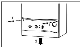
Рисунок 10.1 Вынимание двух шурупов
