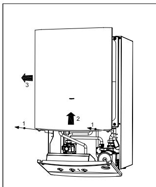
Рисунок 7.6 Снятие окрашенной крышки
