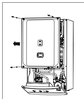
Рисунок 10.4 Снятие крышки камеры сгорания
