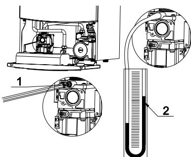
Рисунок 8.1 Подключение манометра
