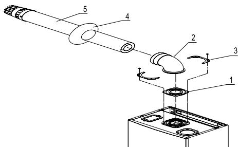
Рисунок 7.9 Монтаж коаксиального дымохода
