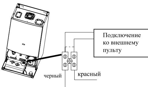
Рисунок 7.13 Подключение комнатного термостата
