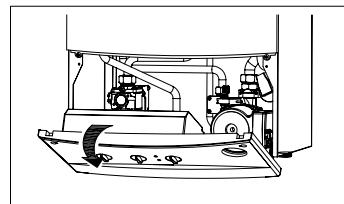
Рисунок 7.5 Снятие пластиковой крышки
