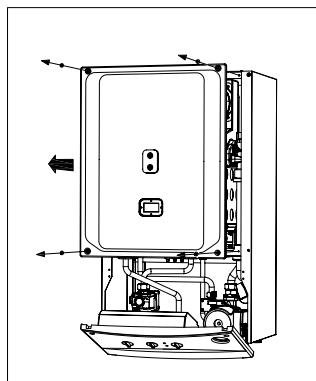
Рисунок 7.7 Снятие крышки камеры
