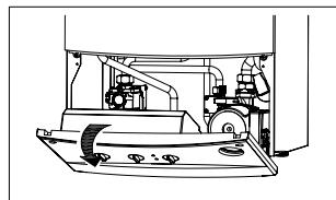
Рисунок 10.2 Снятие пластиковой крышки
