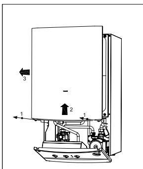
Рисунок 10.3 Снятие окрашенной крышки
