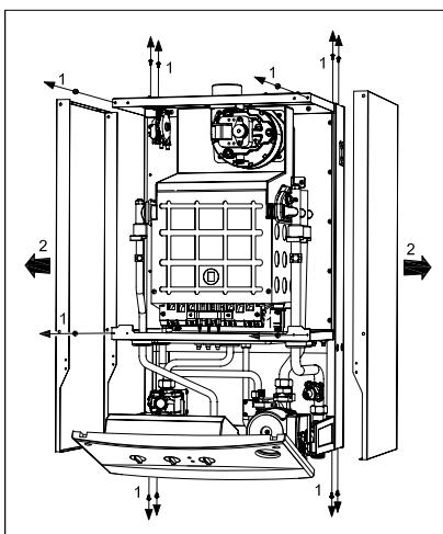
Рисунок 10.6 Снятие двух боковых панелей
