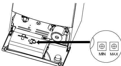
Рисунок 8.2 Задание максимальной тепловой нагрузки
